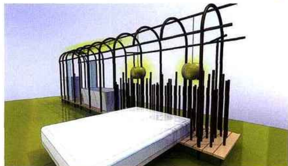
La baignoire, le lavabo et la douche sont montés sur un socle qui cache les connexions techniques. « L'ensemble constitue une sorte de ponton en teck surmonté par une structure d'arceaux ouverts en châtaignier tressé », explique Matali Crasset.
